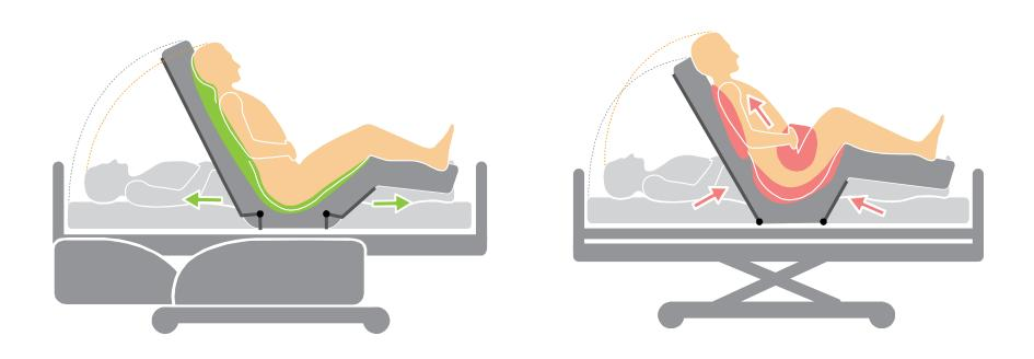
Удобная механическая регулировка за счет кулисного механизма позволяет настраивать спинную секцию кровати и опору для ног. Подставку для ног можно с помощью ручки установить в одно из 5 положений. Эффективная профилактика пролежней обеспечивается за счет системы Ergoframe®, которая сокращает давление в частях тела пациента, подверженных наибольшему риску.
