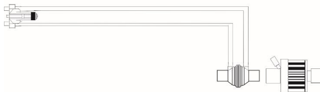
Рис. 83. Соединение сенсора потока с дистальным клапаном выдоха
