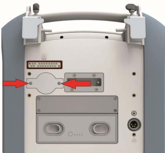
Рис. 136. Извлечение болтов из крышки сенсора O 2
