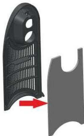
Рис. 131. Замена фильтра грубой очистки.
