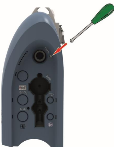
Рис. 133. Извлечение болта из боковой стенки
