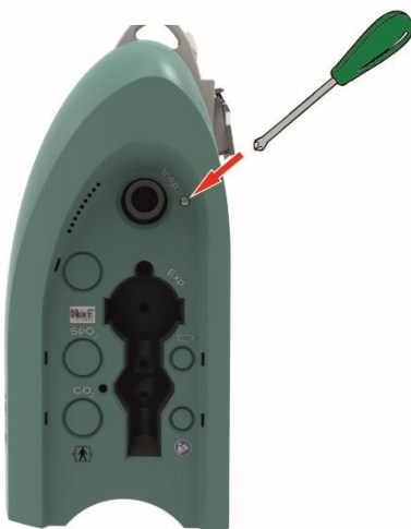
Рис. 134. Извлечение болта из боковой стенки
