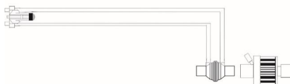
Рис. 83. Соединение сенсора потока с дистальным клапаном выдоха
