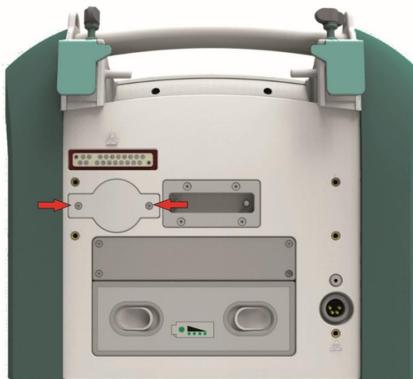
Рис. 137. Извлечение болтов из крышки сенсора O 2
