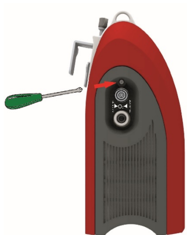
Рис. 96: Удаление винта из боковой панели
