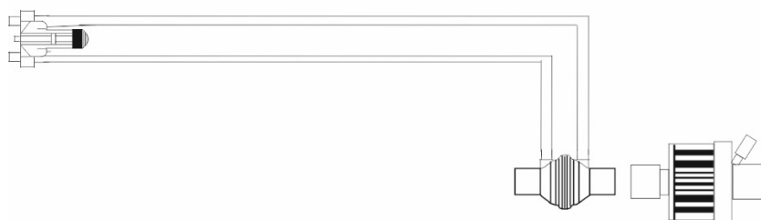
Рис. 61: Подключение датчика потока с дистальным экспираторным клапаном
