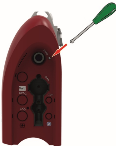
Рис. 99: Удаление винта из боковой панели
