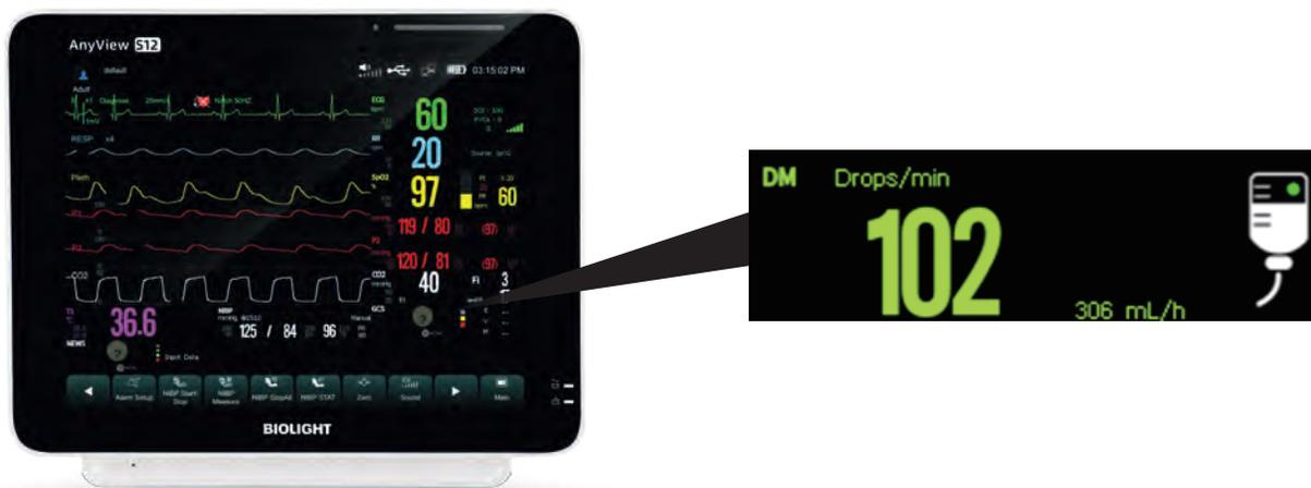
Модуль непрерывно контролирует скорость вливаний во время инфузии. Когда инфузия будет завершена, модуль заметит инфузионную трубку, чтобы избежать повторного поступления крови.
