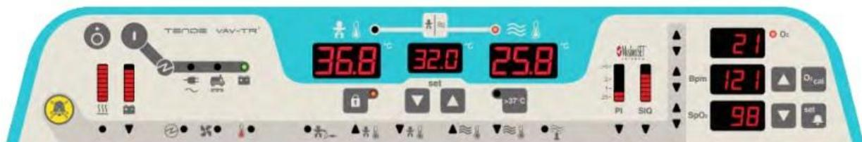
Транспортный инкубатор VAV-TR оснащен эргономичной панелью управления, управляемая современным микропроцессором. Все параметры легко отображаются на светодиодном дисплее, а все необходимые настройки и установки можно выполнить с помощью мембранных клавиш, расположенных на лицевой панели управления.
