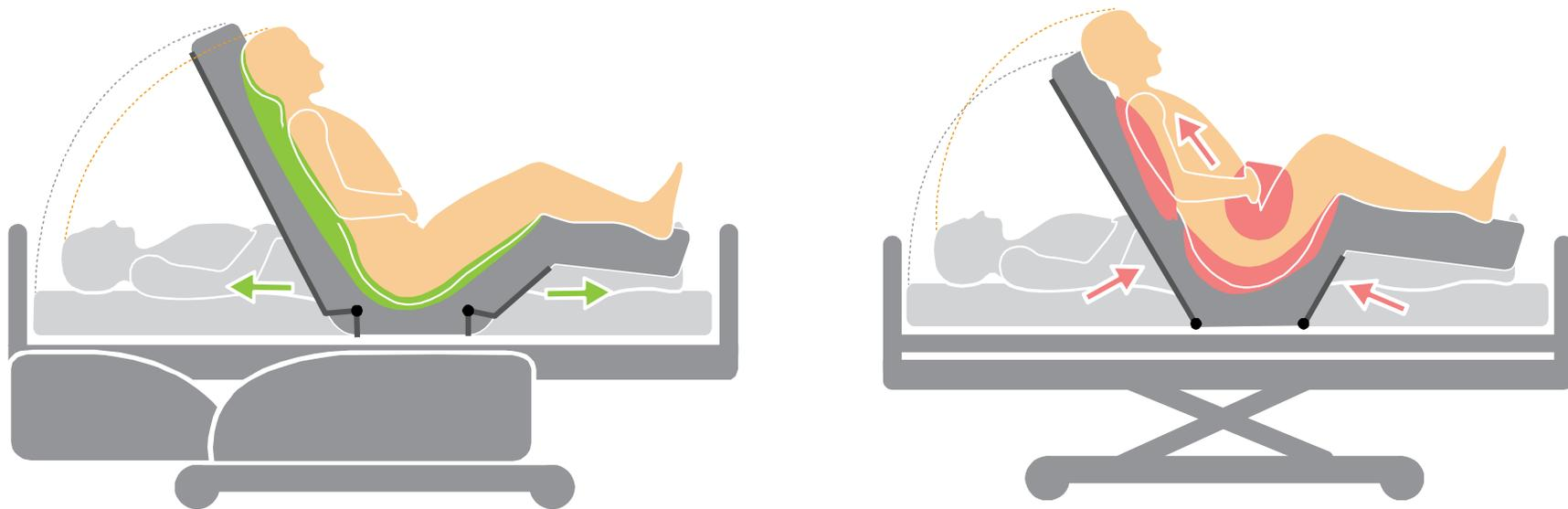
Удобная механическая регулировка за счет кулисного механизма позволяет настраивать спинную секцию кровати и опору для ног. Подставку для ног можно с помощью ручки установить в одно из 5 положений. Эффективная профилактика пролежней обеспечивается за счет системы Ergoframe®, которая сокращает давление в частях тела пациента, подверженных наибольшему риску.
