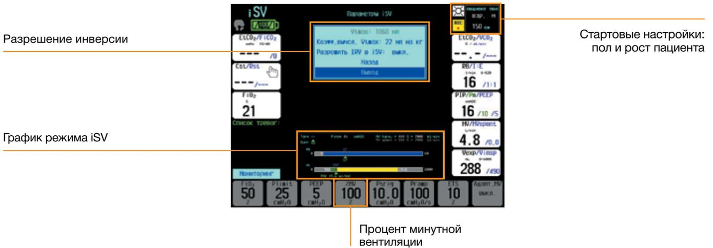
Режим интеллектуальной адаптивной вентиляции обеспечивает целевой объем минутной вентиляции независимо от спонтанной дыхательной активности пациента. Кроме того, режим iSV автоматически регулирует уровень давления поддержки после каждого дыхательного цикла.
