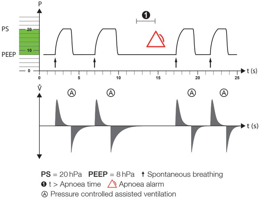
Figure 37: PSV-S mode diagram
